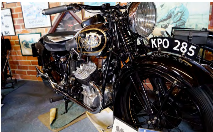
AJS 500 model S3 z początku lat 30. Motocykl z silnikiem V, ale ustawionym poprzecznie.
