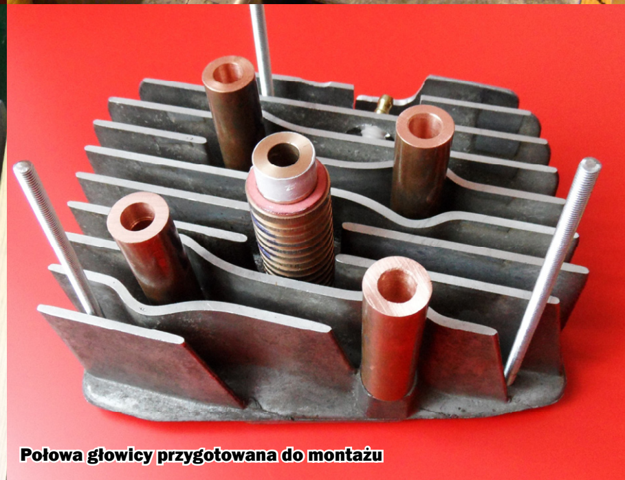
Tulejki przygotowane do wkręcenia w blok silnika
